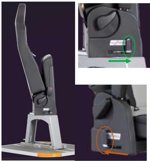
Den **Verstellhebel** nach vorne ziehen dann den Sitz (mit beiden Händen) in die gewünschte Position drehen. Bei Erreichen der Drehposition (Vierteldrehung) rastet der **Verstellhebel** durch Federspannung in die **Ausgangsposition** ein.
