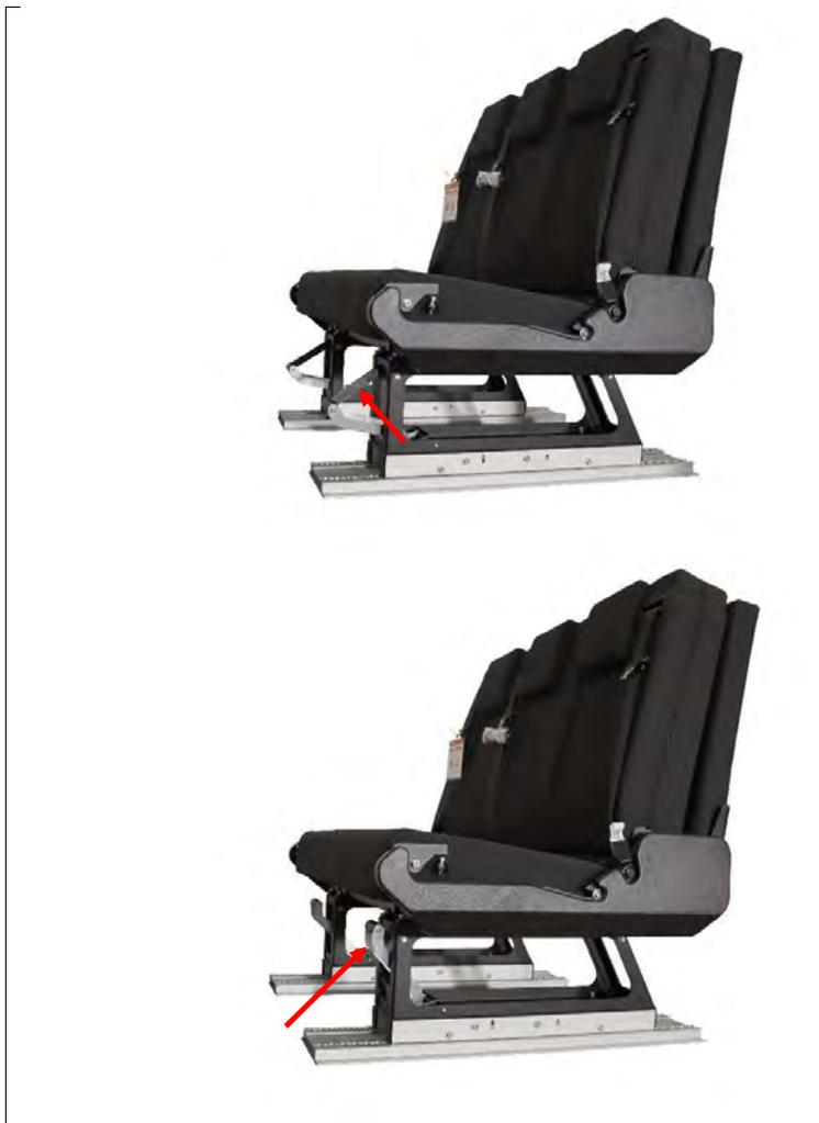
Die Bank in die gewünschte Position verschieben und danach die Arretiersperren entfernen.
