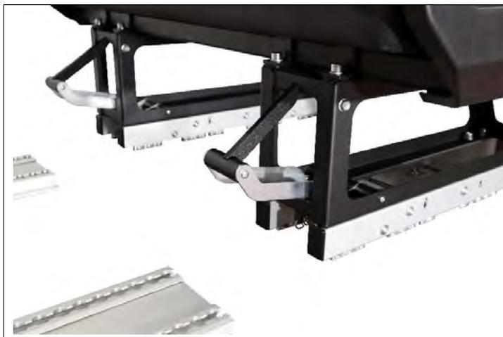
Die SL-3 Bank muss mit **mind. zwei Personen** in das Fahrzeug eingeschoben und auf die Aluminiumprofile gesetzt werden.
