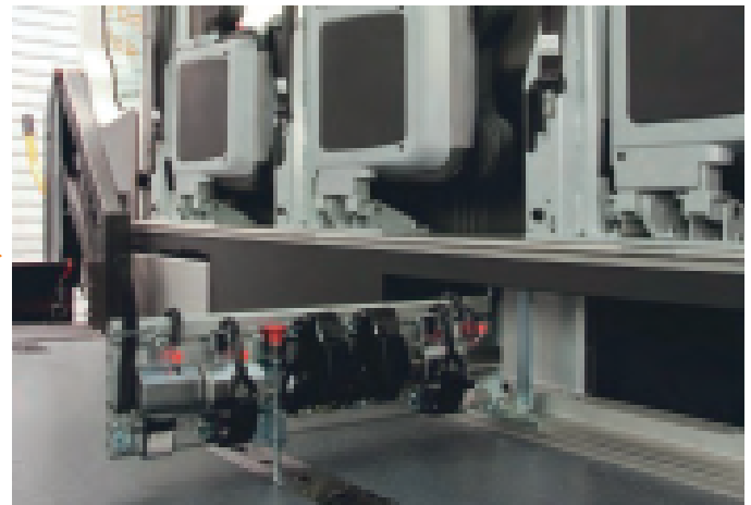
🇩🇪 Alles am mittleren Tragarm: Hintere Verspannung und Beckengurt für den vorderen Rollstuhl, vordere Verspannung für den hinteren Rollstuhl 🇬🇧 Everything fitted to the central support arm: lap belt and rear restraint for the wheelchair in front, front restraint for the wheel chair behind 🇫🇷 Tout se trouve sur la traverse: Enrouleurs arrière pour le fauteuil à l'avant. Enrouleurs avant pour fauteuil à l'arrière. Ceinture abdominale pour fauteuil à l'avant.
