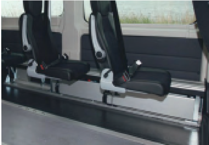
🇩🇪 Einsatzbereite Rollstuhl-Rückhaltesysteme in der Seitenwand, geschützt vor Schmutz und Beschädigung 🇬🇧 Wheelchair restraint systems stowed in the side wall for quick and easy access and protection against dirt and damage 🇫🇷 Ceintures de retenue pour fauteuil roulant prêtes à l'emploi, rangées dans le caisson latéral
